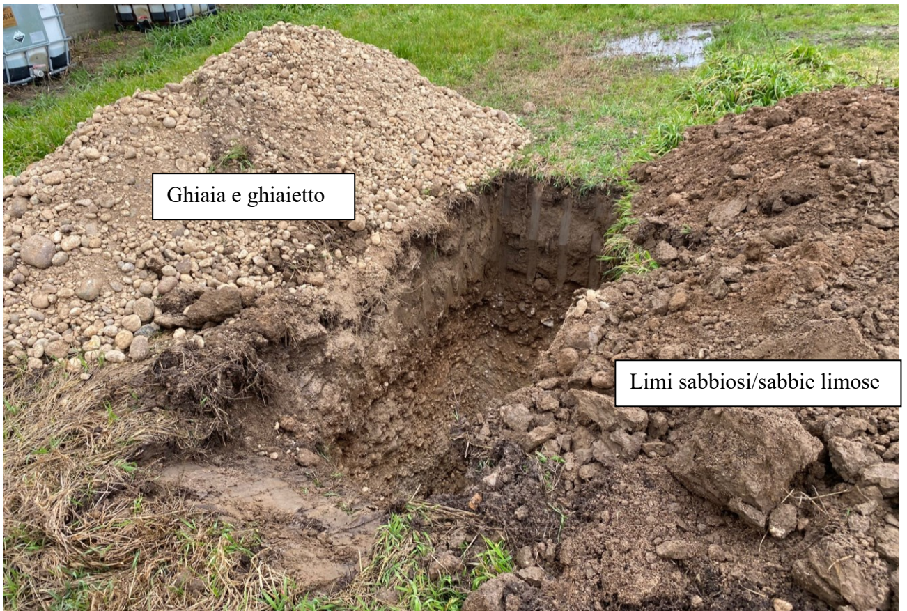
Foto 3: particolare dei materiali estratti in S1
